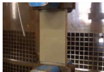
ひび割れ追従性確認の状況
